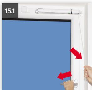
*Stellen Sie den Griff auf Flügelöffnung (nicht auf Kippen) und ziehen Sie an der Schnur der Verriegelung um zu öffnen. (Die Verriegelung ist ja schon montiert und damit aktiv. Das bedeutet, wie bereits beschrieben, dass der Flügel nur durch Ziehen an der Schnur ganz geöffnet werden kann).*
