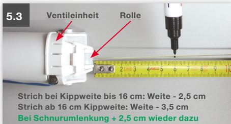
Bei einer Kippweite bis 16 cm ziehen Sie 2,5 cm von der Weite ab, ab 16 cm Kippweite 3,5 cm abziehen. Markieren Sie dann diesen Punkt an der Schnur, wobei Sie hierzu die Entfernung zur Rolle nehmen. Bei Verwendung der Schnurumlungung nach Abzug der 2,5 oder 3,5 cm wieder 2,5 cm dazu rechnen.
