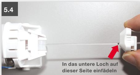
Nehmen Sie den Einhängeknopf und fädeln Sie die Schnur durch das untere Loch, bis die Markierung an der Schnur das Loch erreicht. Achten Sie auf die Ausrichtung des Einhängeknopfes. Sollte sich die Schnur nicht einfädeln lassen, schneiden Sie mit einer Schere das Schnurende spitz zu.
