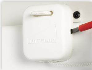
*Wollen Sie die Zugschnur tauschen, dann entfernen Sie den Deckel der Abdeckung und fädeln Sie Ihre neue Schnur so ein, wie die alte Schnur eingefädelt war. Machen Sie nach dem Durchfädeln der Schnur von unten einen festen Knoten (zweimal durchfädeln beim Knopf, wie bei Montagepunkt 16.2) in die Schnur, damit diese beim Zurückziehen des Schiebers nicht durchrutscht.*
