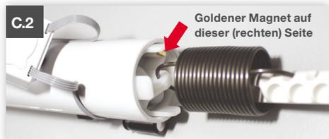
*Ziehen Sie die Federeinhängung heraus und hängen Sie die Feder beim Zapfen hinten am Zylinder ein. Zugfeder umhängen, Feder spannen und vom Zylinderzapfen lösen und die Federeinhängung wieder aufstecken.*
