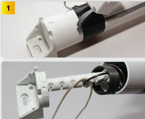
Damit Sie den Elnhängeknopf ausfädeln können, müssen Sie die Zugfeder aushängen. Ziehen Sie dazu die Federeinhängung hinten aus dem Winflip-Hauptteil und hängen diese beim Zylinderzapfen ein. Fädeln Sie dann eine Schnur bei der Zugfeder ein.
