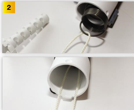
Hängen Sie die Zugfeder bei der Federeinhängung aus und lösen Sie diese dann vom Zylinderzapfen, indem Sie bei der Schnur anziehen. Lassen Sie diese in den Winflip-Hauptteil hinein. Durch die Schnur können Sie diese später wieder nach hinten ziehen.
