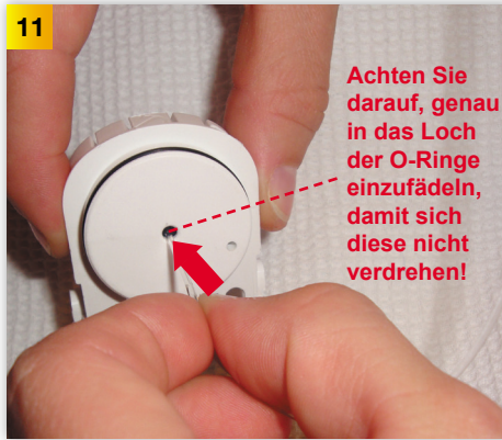
11 Monofilamentschnur durch die Ventileinheit fädeln (genau in der Mitte durch das Loch!).
