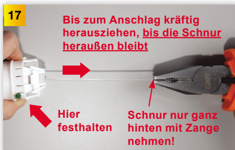
17 Drücken Sie dann den Rollenbügel wieder von oben auf die Ventileinheit. Ziehen Sie die transparente Schnur kräftig mit der Kombizange bis zum Anschlag aus dem Hauptteil. Sie benötigen hierfür eine Zugkraft von ca. 8 kg. Die Schnur muss zum Einhängenknopf auffädeln herausen sein (nicht eingezogen).
